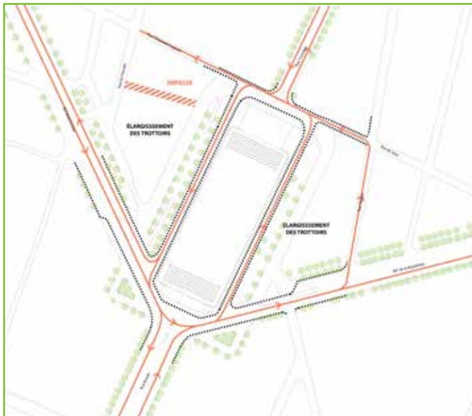
Principe 1 : Élargissement des trottoirs latéraux
