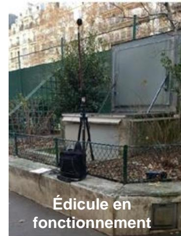
Mesures acoustiques réalisées pour caractériser le bruit:
