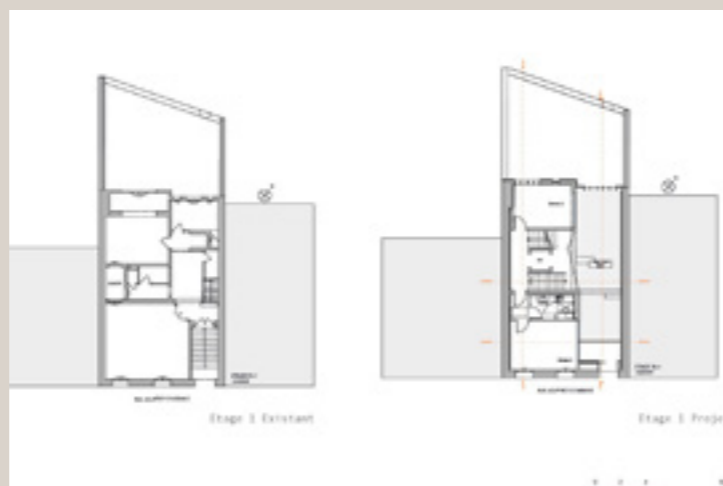
Plan du rez-de-chaussée, états existant (à gauche) et projeté (à droite) (© Bouchaud architectes).
