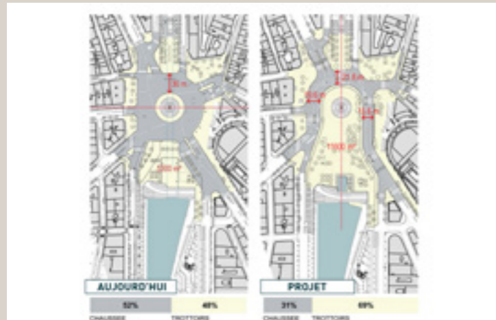
Plan d'aménagement de la place de la Bastille, état existant et projet (© Atelier CAP).
