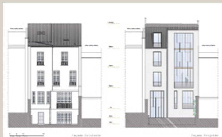
Élévation de la façade sur cour, états existant (à gauche) et projeté (à droite) (© Bouchaud architectes).
