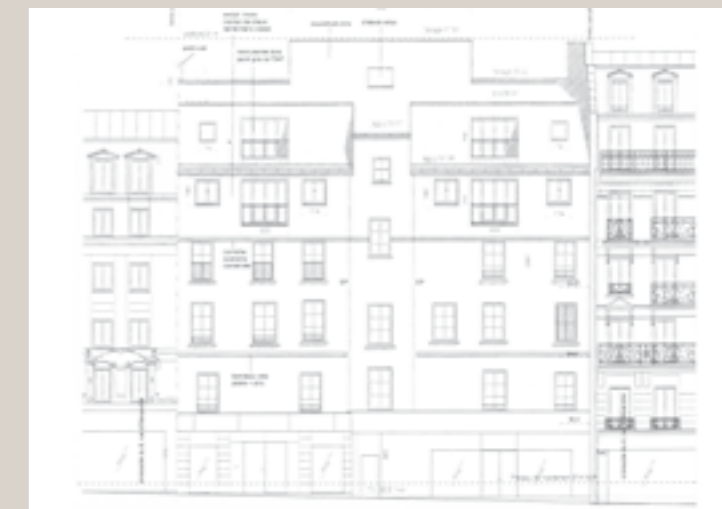
Élévation de la façade sur rue, état projeté (© Copin & Dupeyrou).
