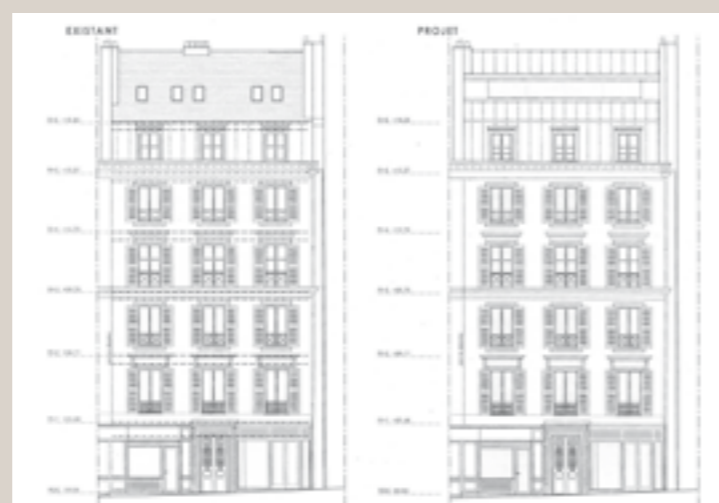
Élévation de la façade sur rue, états existant (à gauche) et projeté (à droite) (© Didier Drummond).
