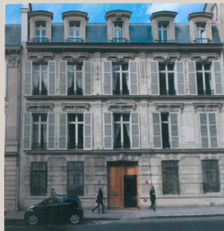
Vue d'insertion de la façade sur rue, projet présenté en novembre 2017, montrant l'agrandissement des ouvertures au rez-de-chaussée (© HW Architecture).
