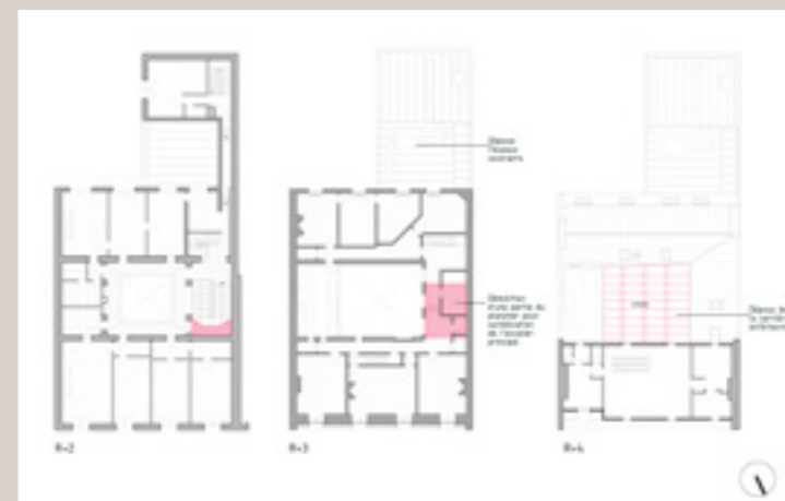
Plan des étages R+2 à R+4, état existant présentant les modifications envisagées dans le nouveau projet (© Sébastien Héry architecte).
