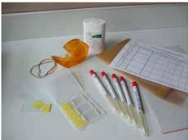
*Kits composés d'écouvillons et de rubans adhésifs permettant d'identifier les moisissures présentes sur 5 supports échantillonnés, par deux techniques complémentaires*
