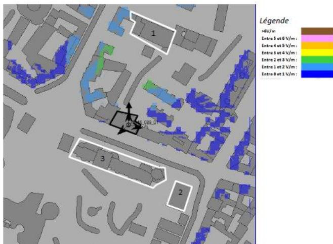
Pour l'antenne orientée dans l'azimut 100°, le niveau maximal calculé en intérieur est compris entre 4 et 5 V/m. La hauteur correspondante est de 18 m.
