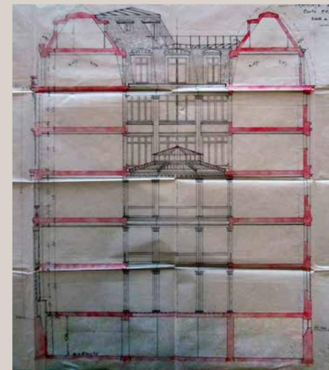
Coupe transversale où l'on devine le plancher de verre au centre du rez-de-chaussée, dressée par Ulmann en 1900 (Archives de Paris).
