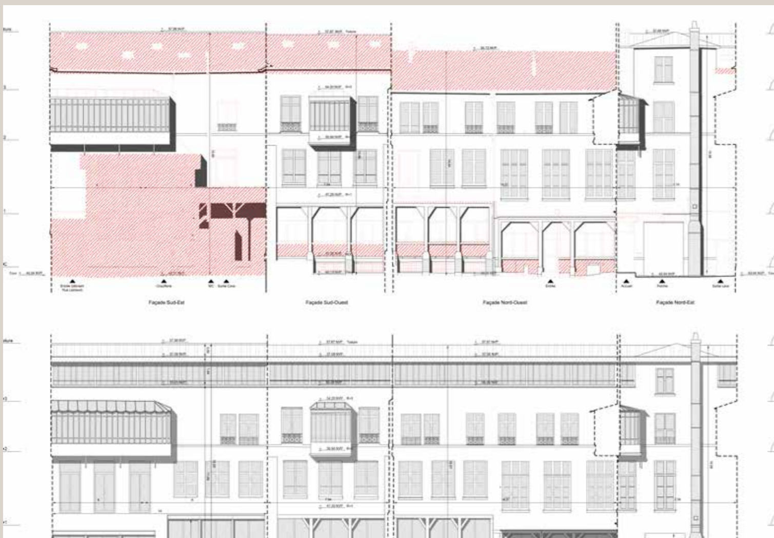
Élévation des façades sur cour, état existant présentant les démolitions envisagées (en haut) et état projeté (en bas) (© DATA architectes).
