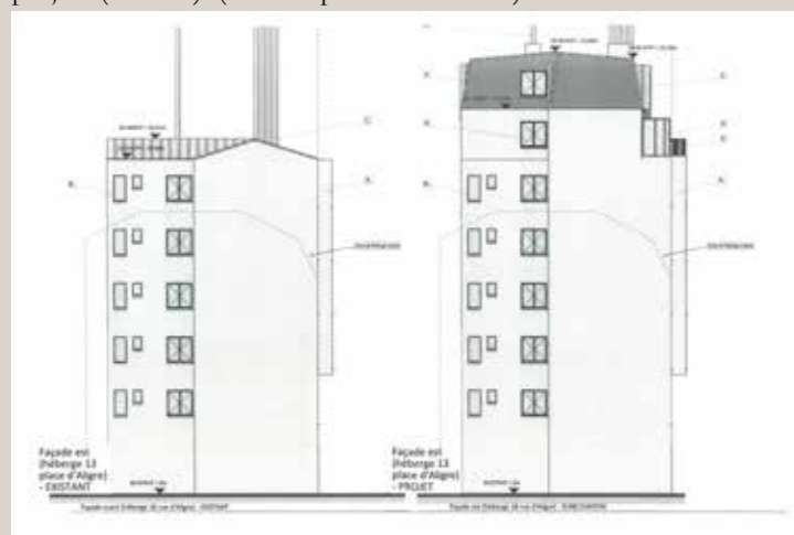
Élévation de la façade ouest (Place d'Aligre), états existant (à gauche) et projeté (à droite) (© Kanopia Architectures).
