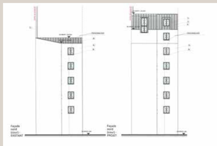
Élévation de la façade nord (côté cour), états existant (à gauche) et projeté (à droite) (© Kanopia Architectures).
