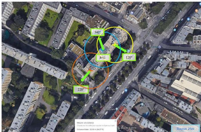
Dans un rayon de 25m, la hauteur au niveau des antennes est supérieure à tous les bâtiments alentours. Il n'y a donc aucun bâtiment en vue directe depuis les 3 azimuts.
